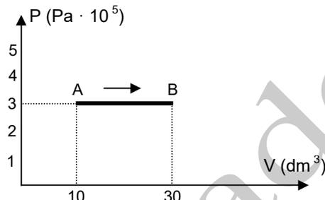
Determinare la temperatura corrispondente allo stato finale, il calore che deve essere fornito al gas per produrre la trasformazione, la variazione dell'energia interna del gas e il lavoro effettuato dal gas.
