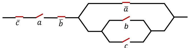
9. Determina la proposizione corrispondente al circuito a lato. Semplifica la proposizione ottenuta utilizzando le proprietà dei connettivi logici e disegna il circuito equivalente più semplice.
